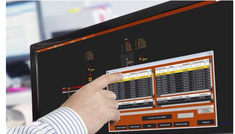
Der Process Recorder zeichnet Daten in der zenon Service Engine auf, die später im Projektsimulationsmodus wiedergegeben werden. Damit können Störungen im Nachhinein genauer analysiert werden (Post-Mortem-Analyse). Auch Simulationen und Trainings neuer Mitarbeiter können mit dem Process Recorder anschaulich durchgeführt werden.
