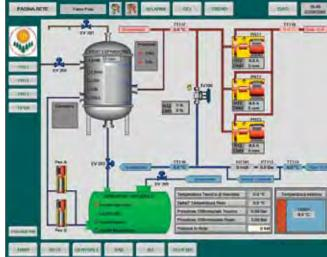
straton ist aber nicht nur auf der I/O Ebene im Einsatz. Als vielfältiges Instrument übernimmt es auch als eingebettete Lösung wichtige Aufgaben bei der Steuerung des Druckausdehnungsgefäßes. Die Normvorschrift verlangt hier aus Sicherheitsgründen den Einsatz einer Hard-SPS. Auch wenn das Gerät seine Anbindung ans Netzwerk verliert, muss die kontrollierte Steuerung des Gefäßes gewährleistet sein.
