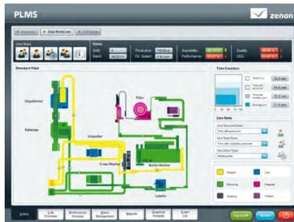
Abbildung 1: Übersicht über eine Verpackungslinie in zenon
