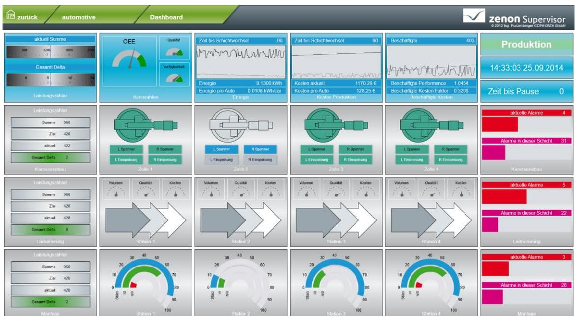
Durch die Zusammenführung von unterschiedlichsten Daten in eine „Cockpit“ Anzeige stehen für den Anwender alle Informationen auf einem Blick zur Verfügung.
