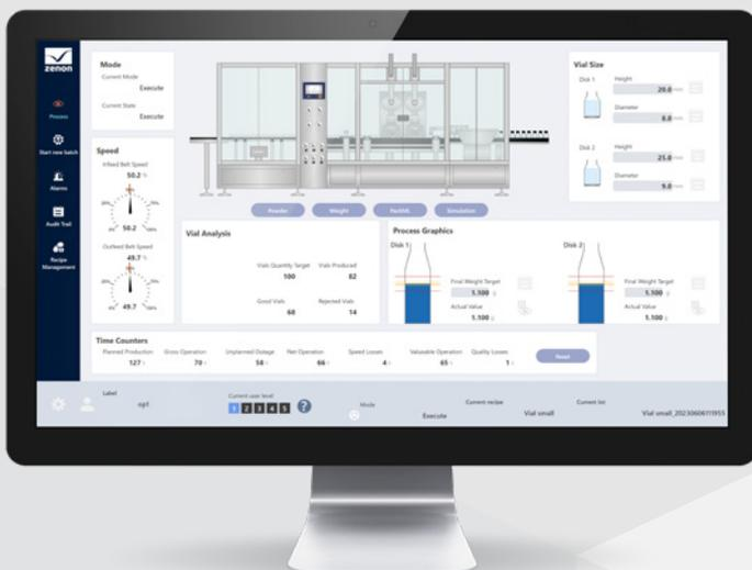
Abbildung 2: Pharma HMI Demo im Web Visualization Service
