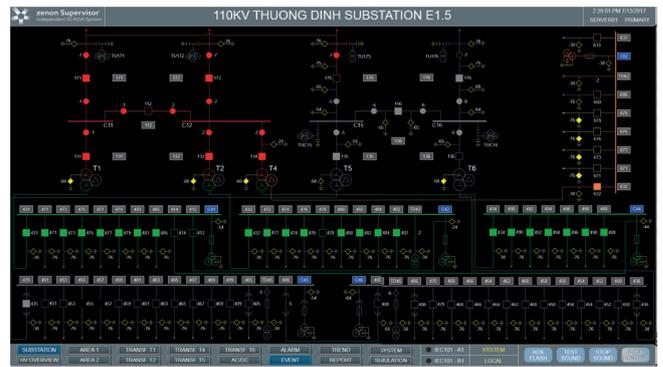
Contrôle absolu : Les schémas unifilaires transmettent des informations vitales sur les différents niveaux de tension (110 kV, 35 kV et 22 kV) au sein de la sous-station.
