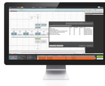
Command Sequencer est utilisé pour la configuration de séquences de commandes. Il est constitué d'un éditeur graphique, dans lequel les commandes (étapes) d'une séquence de commandes peuvent être disposées de manière séquentielle. Ces séquences peuvent être testées, exécutées et modifiées selon le besoin. Il n'est donc plus nécessaire de programmer des automates, l'utilisateur peut simplement les configurer, les tester et les modifier lui-même.
