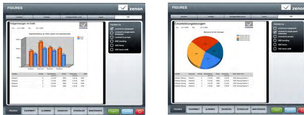
Die zenon-Anwendung zeigt sehr anschaulich die Störzeiten der Anlage (links) sowie die Einzelstörungen an verschiedenen Robotern (rechts) – einmal in ihrer gesamten, einmal in der pausenbereinigten Dauer.
