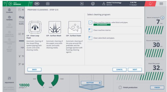
SIG NEO verfügt über eine automatisierte Reinigungsfunktion. Auch hier leitet das HMI intuitiv durch den Prozess.
