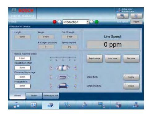
Die Produktions-Anzeige informiert die Bediener bei Bosch Packaging Systems über alle relevanten Parameter. Der obere Bildabschnitt zeigt Informationen zu den Produktabmessungen (links) sowie zur Maschinengeschwindigkeit (rechts). Per Eingabefelder (Bildmitte, links) können die Bediener Offset-Korrekturen zur Produkt- bzw. Folienpositionierung vornehmen.
