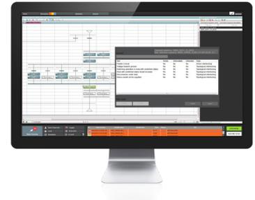
Der Command Sequencer dient zur Konfiguration von Schaltfolgen. Er umfasst einen grafischen Editor, in dem die Befehle (Schritte) einer Schaltfolge aneinandergereiht werden. Diese Schrittketten können getestet, ausgeführt und bei Bedarf geändert werden. Eine SPS-Programmierung für Schaltfolgen ist damit nicht mehr notwendig, der Bediener kann sie selbst konfigurieren, testen und anpassen.
