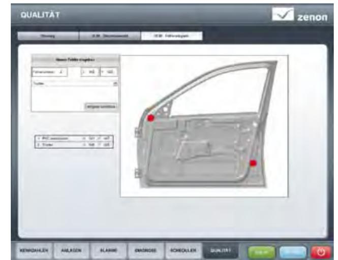
Fehlerarten, Erfassungsstationen und Fahrzeugfarben filtern. HTML-Auswertungen lassen sich automatisch erstellen; Sprungfunktionen innerhalb der HTML-Seiten führen die Benutzer zu den Detailansichten. Diese Darstellung und die Auswertungen der Fehler und Nacharbeiten lassen Rückschlüsse zu, bei welchen Komponenten oder in welchen Prozessen Maßnahmen zur Optimierung der Produktionsqualität eingeleitet werden müssen.
