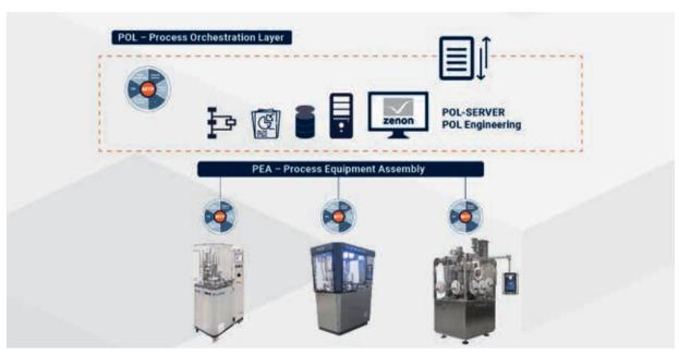
Abbildung 2: Integration von MG2-Geräten in die POL über MTP
