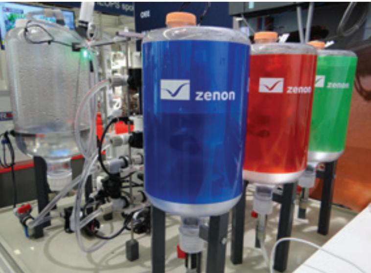
Abbildung 2: Das portable Tankmodell liefert Echtzeit-Werte verschiedenster Sensoren an zenon und funktioniert ähnlich einer realen Produktivanlage.
