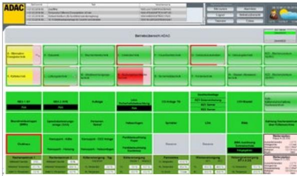
Abbildung 1: Zustandsdarstellung aller Gewerke in einer Übersicht. Störungen und Meldungen werden farblich hervorgehoben.
