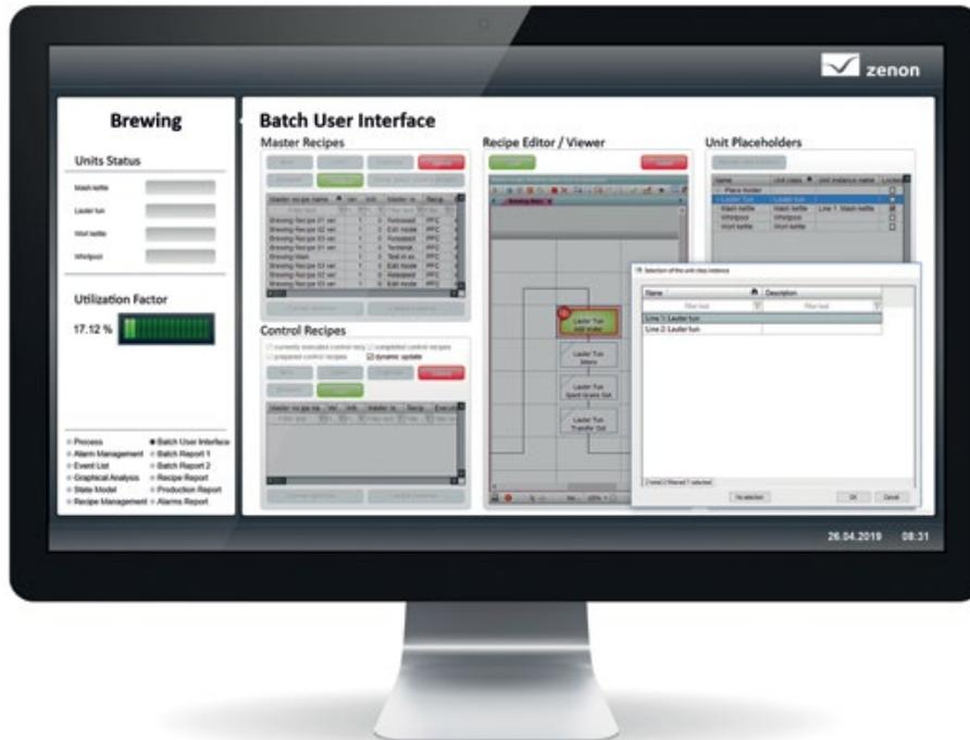
Abbildung 3: Batch-Control-Bild mit aktivierter Platzhaltergrundfunktion und Instanzauswahldialog.
