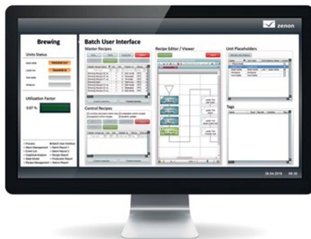
Abbildung: Bei den Aggregatsklassen wird erst beim Start des Prozesses das Equipment definiert, mit welchem dieser ausgeführt wird.
