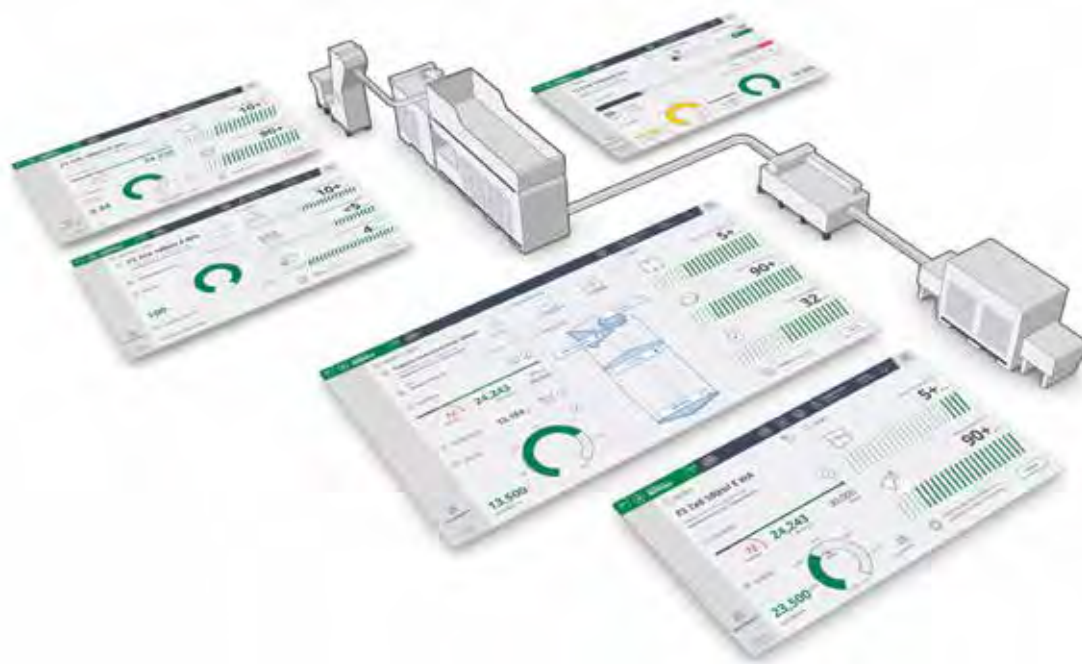
Die Linienübersicht bietet den Nutzern die Möglichkeit, Prozesse der Abfüllung und Anlagennutzung detailliert nachzuvollziehen und Optimierungen vorzunehmen.
