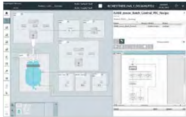
Über das zenon Batch Control werden die einzelnen Module, die für eine Rezeptur benötigt werden, orchestriert und gesteuert.
