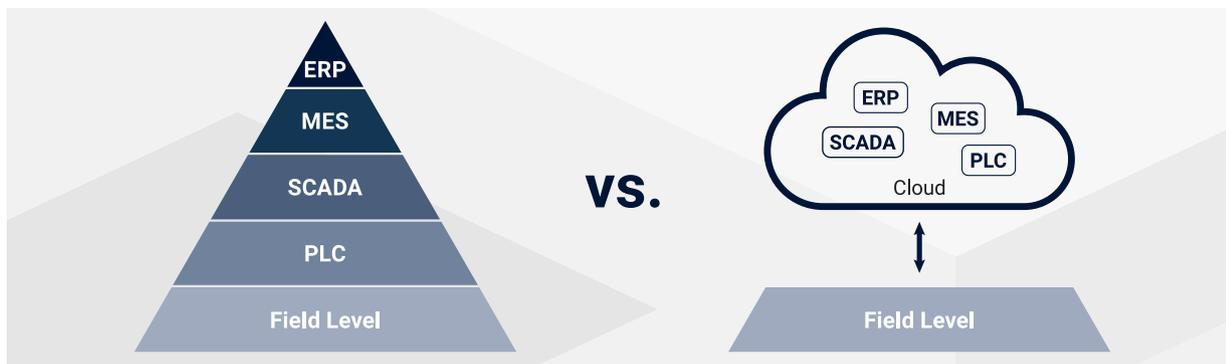
Abbildung 2: Vergleich von klassischer und „As a Service“-Automatisierung
